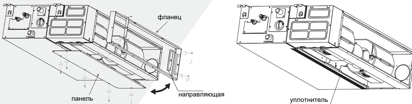
Для смены направления воздушного потока необходимо снять фланец, снять защитную крышку с нижней части внутреннего блока и поменять их местами.
