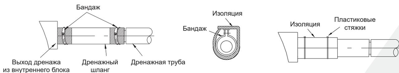
Дренажная труба должна быть зафиксирована, чтобы не образовывать петли, где будет застаиваться вода.
