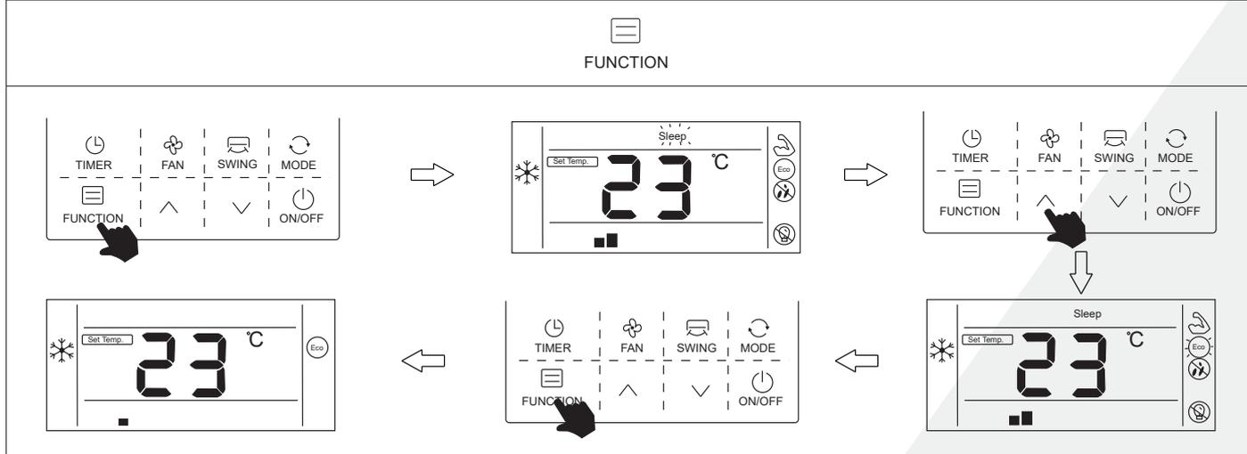
Список функций отображается в правом столбце на дисплее пульта управления и выбирается нажатием кнопок ▲ и ▼. Часть функций может быть недоступна в вашем оборудовании.
