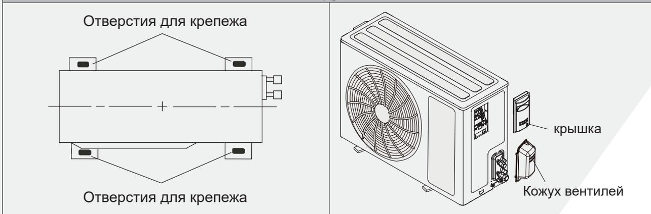
Зафиксируйте наружный блок 4 болтами.
